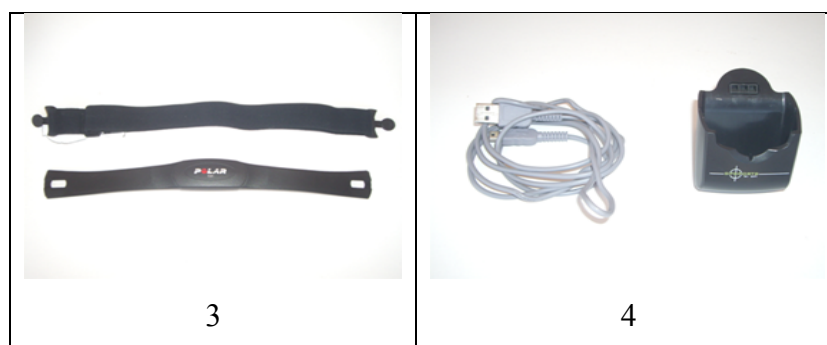
Figura 19. Receptor SPI Elite (1), arnés (2), transmisor de frecuencia cardiaca (3), base para la transmisión de los datos al software Team AMS (4).
